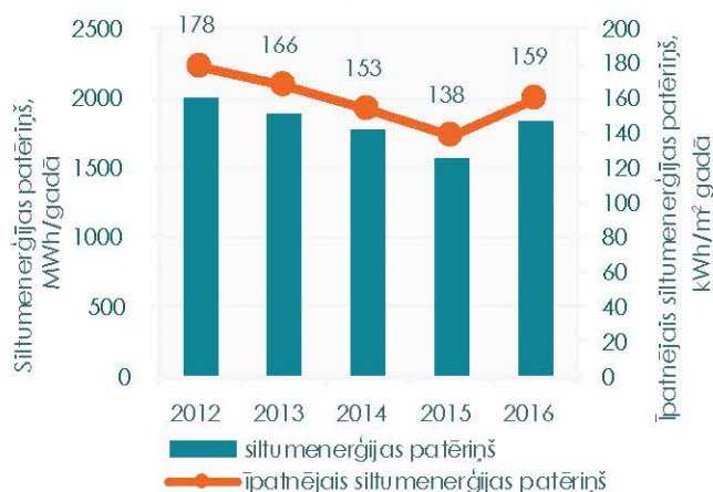
2.13. ATTĒLS: Kopējais un īpatnējais siltumenerģijas patēriņš dzīvojamā fonda ēkās 2012.-2016.gadā Pilsrundālē (apakšā) un Saulainē (augšā)
