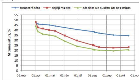
4.3. ATTĒLS: Malkas pagales sagatavošanas pakāpes ietekme uz mitruma saturu žūšanas periodā 15
