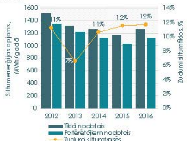
2.12. ATTĒLS: Tīklos un patērētājiem nodotā siltumenerģijas apjoma izmaiņas un zudumi siltumfīklos Aizkraukles pagasta CSS
