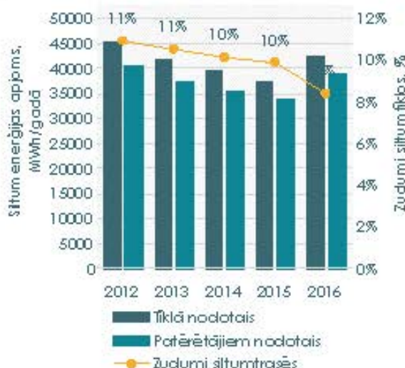
2.10. ATTĒLS. Tīklos un patērētājiem nodotā siltumenerģijas apjoma izmaiņas un zudumi siltumfīklos Aizkraukles pilsētas CSS
