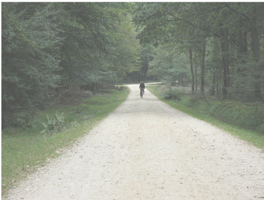
Optimālais gājēju un veloseliņa platums ir 2,2m gājējiem un 1,50m velobraucējiem vienā virzienā
