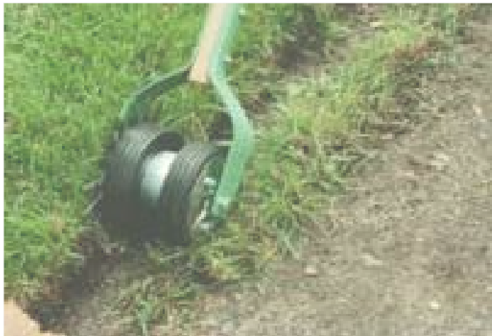
Celiņu malu kopšanas instruments. Veido akurātu celiņa malu, nogriežot zāliena velēnu
